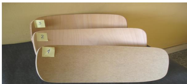
**Obr.7** Laboratórne vyrobené tvarované operadlá. 1 – tvarovaná MDF doska nedyhovaná, 2 - tvarovaná MDF doska dyhovaná, 3 – tvarovaná preglejka,
