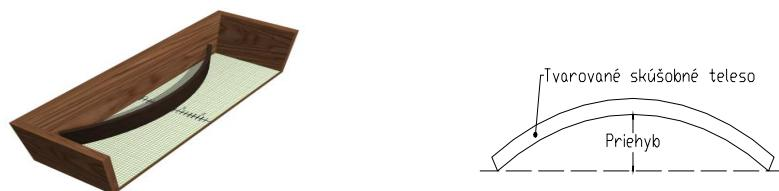
**Obr. 3** Prípravok na meranie priehybu.
