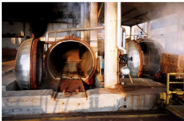
Рис. 4. Общий вид автоклавов, используемых для пропарки деревянных материалов
