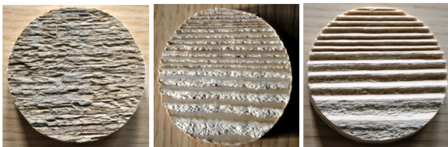
Obr. 6 Reliéf radiálneho povrchu smrekového dreva. a) pôvodný povrch, b) po opracovaní CO 2 (množstvo ľadu 1,6 kg/min pri tlaku 0,5 MPa), c) po opracovaní CO 2 (množstvo ľadu 2,5 kg/min pri tlaku 0,5 MPa)
