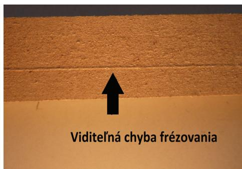
Obrázok 16 Chyba frézovania
