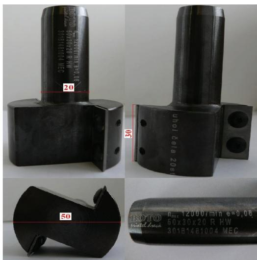
Obrázok 1 Frézovacia hlava
