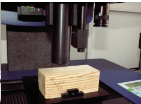
Obr. 4: Měřicí přístroj Talysurf CLI 1000 Obr. 5: Snímání vzorku CLA snímačem
