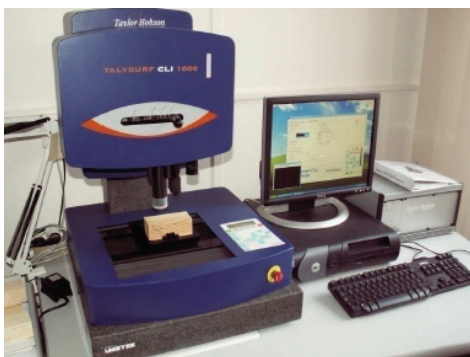
Obr. 4: Měřicí přístroj Talysurf CLI 1000 Obr. 5: Snímání vzorku CLA snímačem
