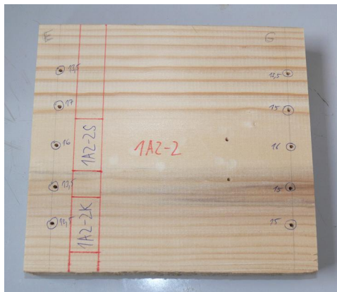
Obr. 4 Spôsob výberu skúšobných telies pre určenie hustoty a vlhkosti dreva gravimetrickou metódou
