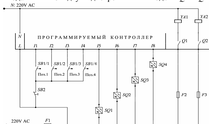
Рис. 2. Электросхема системы автоматического позиционирования бревен
