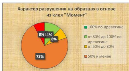
Рис 6. Характер разрушения образцов клеевых соединений на основе различных клеев
