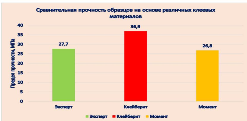
Рис. 5. График сравнения прочности образцов на основе различных клеевых материалов
