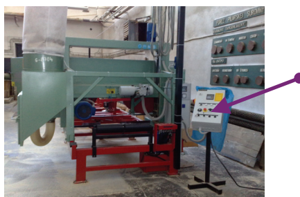
Obr. 2 HPP Mebor HTŽ 1000 – pohľad na ovládací panel
