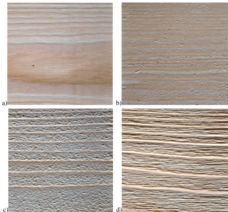
Obr. 6 Povrch smrekového dreva opracovaný a) frézovaním, b) suchým ľadom, c) abrazívom, d) kartáčovaním.
