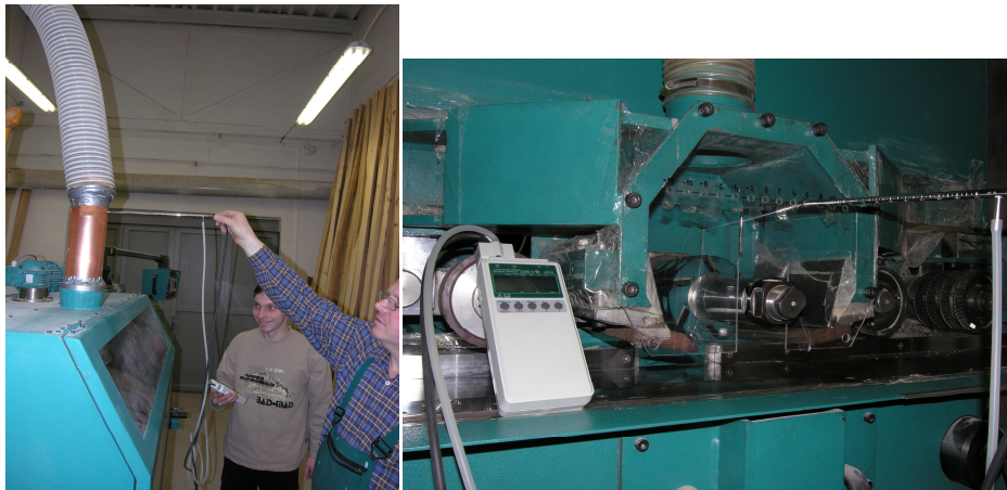
Obr. 7 Měření proudu vzduchu v sacím nástavci a zákrytu
