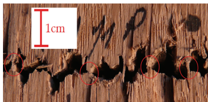
Obrázok 6 Fotografia nedorezania dubovej vzorky pri reznej výške (hrúbke) 75 mm, posuvnej rýchlosti 0,2 \text{ m}\cdot\text{min}^{-1} a hmotnostnom toku 450 \text{ g}\cdot\text{min}^{-1}
