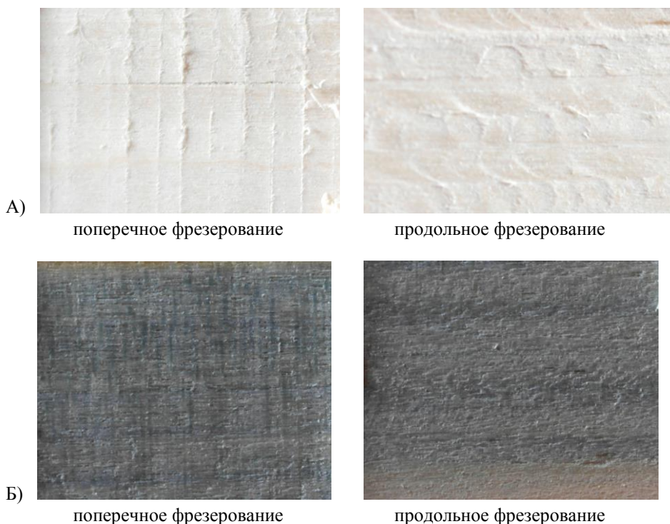
Рисунок 1 – Качество фрезерованной поверхности древесины березы А) непропитанной и Б) пропитанной
