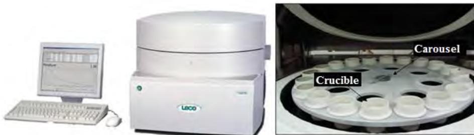
Fig. 4 Thermogravimetric analyzer
