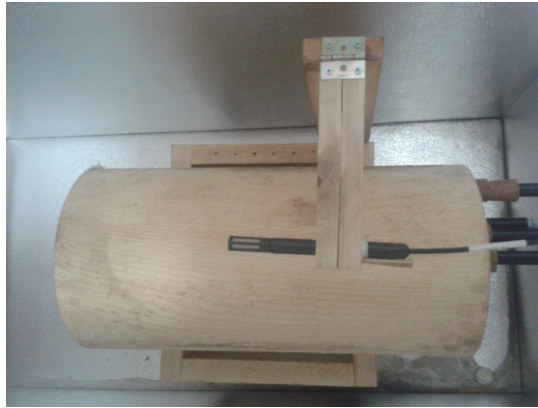
Рис. 3. Измерение T_m во время замораживания и последующего оттаивания кряжей
