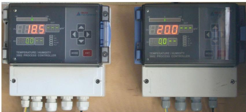
Рис.5 Общий вид программируемых контроллеров, в софтуер которых введены разработанные режимы для пластификации ванчесов
