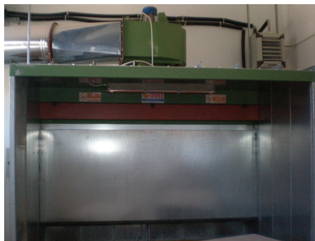
Рис.1 Общий вид кабины для лакирования деревянных изделий
