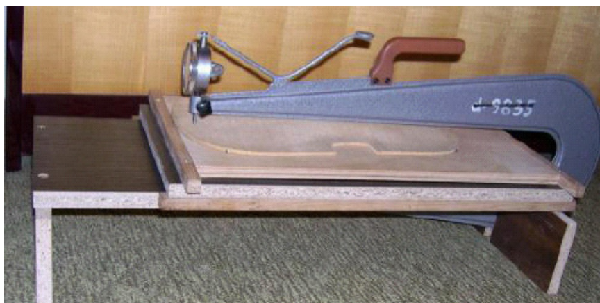
Obr. 3 Pohľad na meracie zariadenie – odchýlkomer a stolík s krížovým suportom.
