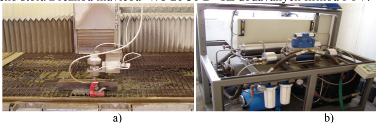
Obrázok 1 Technologické zariadenie na rezanie vodným lúčom DEMA spol. s.r.o. a) pracovný stôl zariadenia b) čerpadlo vysokého tlaku (multiplikátor)
