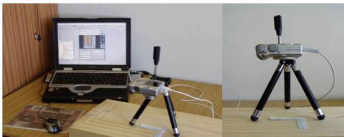
Obrázok 5 Aparatúra pre meranie šírky reznej škáry
