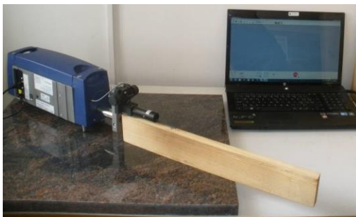
Obr.7 Průběh měření drsnosti
