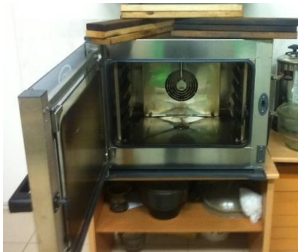
Obr. 2 Laboratorní pec pro termickou úpravu se vzorky
