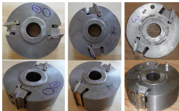
Obr. 4 Frézovací hlavy použité při frézování
