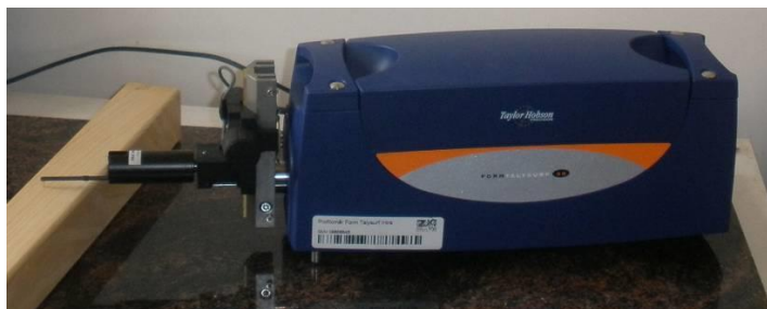
Obr. 5 Drsnoměr Talysurf Intra 2
