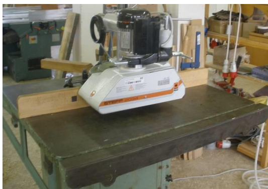
Obr. 3 Frézka s podávacím zařízením
