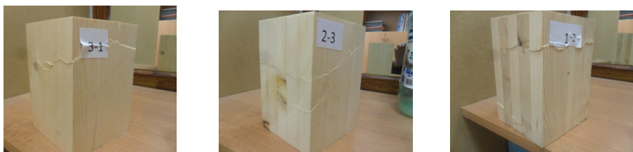
Рис. 2 Образцы испытаний: а – цельный образец древесины, б – продольно склеенный образец, в – перекрестно склеенный образец
