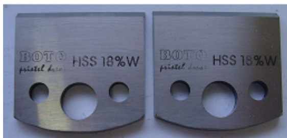
Obrázok 4 Vymeniteľná rezná doštička z rýchloreznej ocele s obsahom Wolfrámu 18 %.
