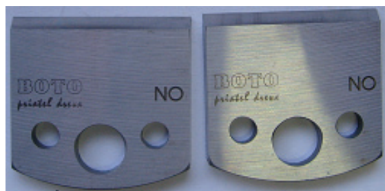
Obrázok 5 Vymeniteľná rezná doštička z nástrojovej ocele
